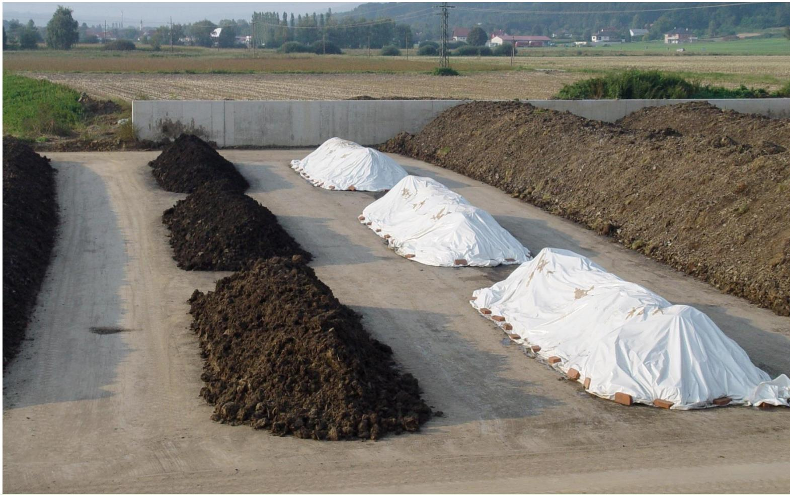
**Tägliches Messen: Temp. CH<sub>4</sub>, CO<sub>2</sub>, O<sub>2</sub>**
